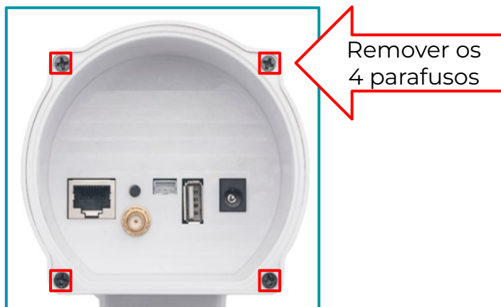
Legenda: Visão da parte de baixo do DTG-084 com indicação dos 4 parafusos.
