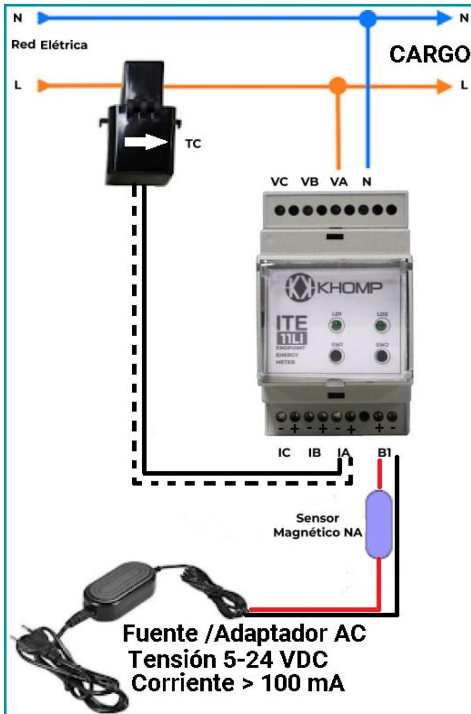
**Leyenda:** ITE 11LI monitoreando la carga monofásica en el Rack del datacenter, en el aire acondicionado, en el freezer o en el motor eléctrico.
